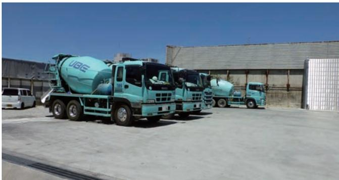
洗車は、建屋東隣りの⑨洗車場で行います。事務所から「出荷終了」の連絡が入ったら、⑦洗い場でくわがいと最終の洗浄を済ませ、⑨洗車場(⑪生コン車用駐車場兼用)で、生コン車外観の洗車を行います。
