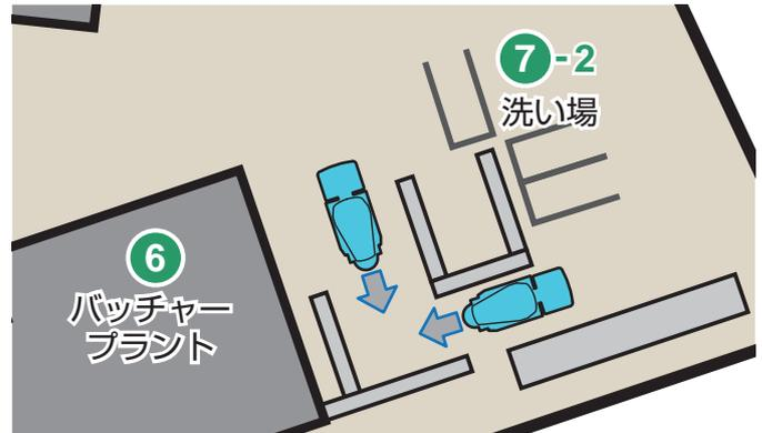
残コンを持ち帰った場合は、事務所に連絡を入れ、⑥バッチャープラントと⑦-2 洗い場の間にある⑧残コン処理場に投入します。
